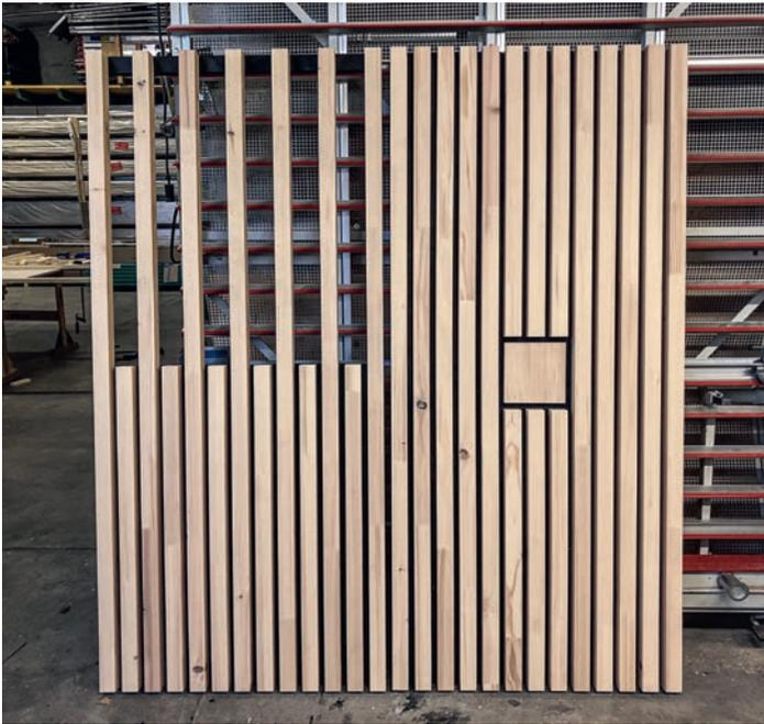
Die 22 000 Meter Holzleisten wurden als vorgefertigte Deckenelemente montiert.
